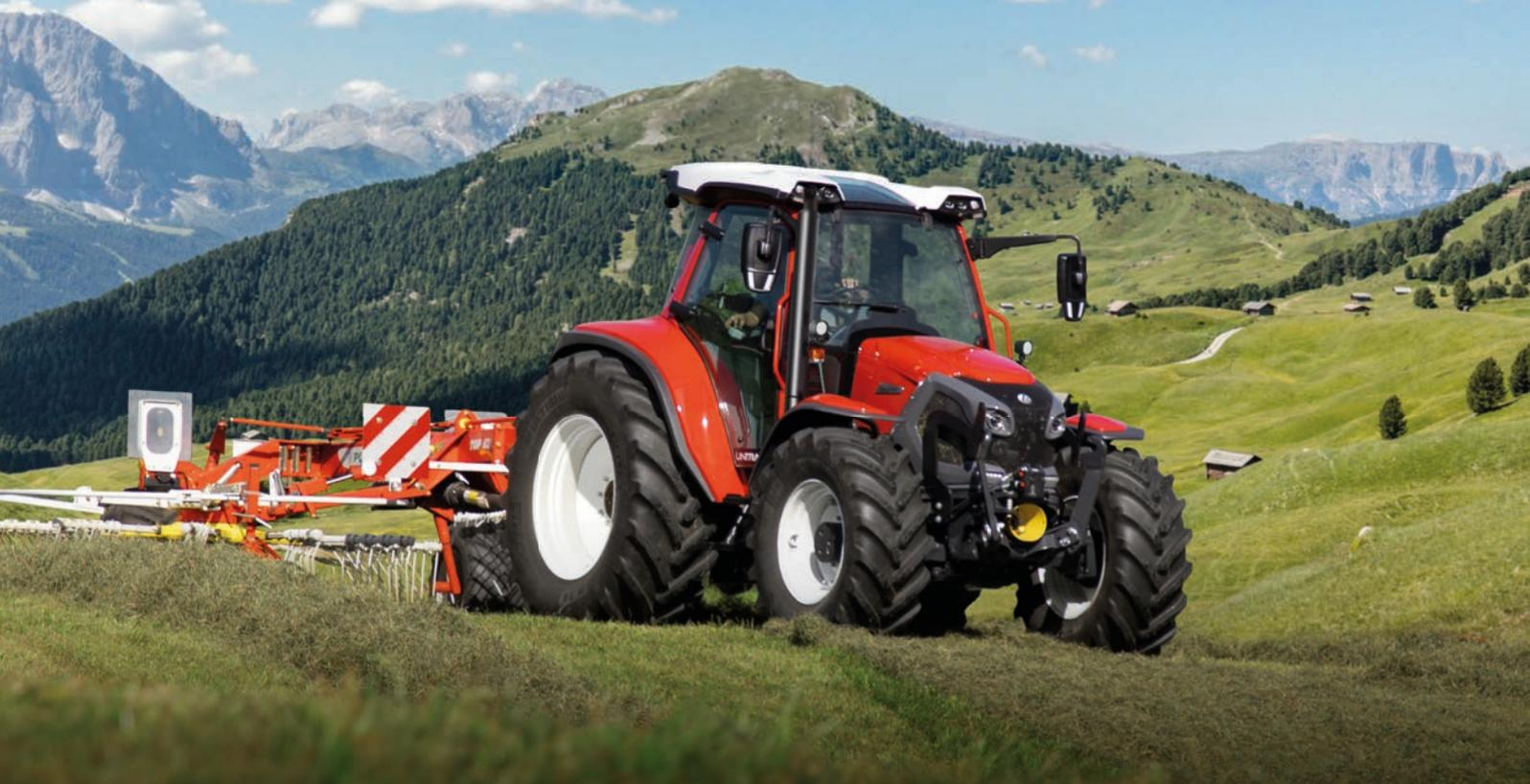
Der Perkins-Syncro-Motor im Lintrac 115 LS bringt es auf **112 PS (82 kW)**. Wie beim Lintrac 95 LS ist ein **16/8-Gang-ZF-Steyr-Lastschaltgetriebe** mit 2-fach-Lastschaltung verbaut. Besonderen Fahrkomfort gewährleistet die **TracLink-Kabine** mit mechanischer Federung und der Komfortsitz mit Luftfederung.
