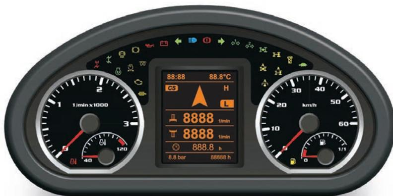
Das zentrale Anzeigeelement mit **I.B.C.-Display** vereint die übersichtliche Darstellung von Zeiger-Instrumenten mit einer intelligenten digitalen Anzeigematrix und informiert den Fahrer über den Zustand von Motor, Getriebe und Hydraulik.
