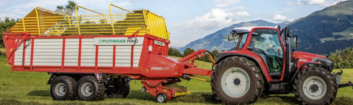
Die neuen Modelle Lintrac 95 LS und Lintrac 115 LS sind die Nachfolger des Geotrac 94 ep/104 ep. Zum Einsatz kommen die neuen Perkins-Syncro-Motoren der Stufe 5. Die sind nicht nur besonders sauber, sondern auch sehr drehmomentstark. Weitere Highlights sind das Lastschaltgetriebe von ZF Steyr und die Hochleistungshydraulik von Bosch-Rexroth mit Axialkolbenpumpe und getrenntem Ölhaushalt.
