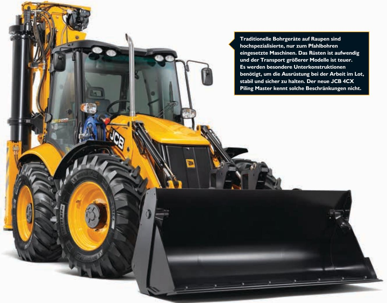
Traditionelle Bohrgeräte auf Raupen sind hochspezialisierte, nur zum Pfahlbohren eingesetzte Maschinen. Das Rüsten ist aufwendig und der Transport größerer Modelle ist teuer. Es werden besondere Unterkonstruktionen benötigt, um die Ausrüstung bei der Arbeit im Lot, stabil und sicher zu halten. Der neue JCB 4CX Piling Master kennt solche Beschränkungen nicht.
