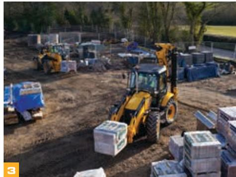
**3** Mit Gabeln an dem integrierten Schnellwechsler bewegen Sie palettierte Lasten bis zu 2 Tonnen. Die Sicht auf die Last ist dabei optimal.
