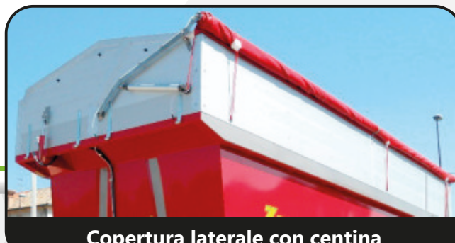
Copertura laterale con centina
