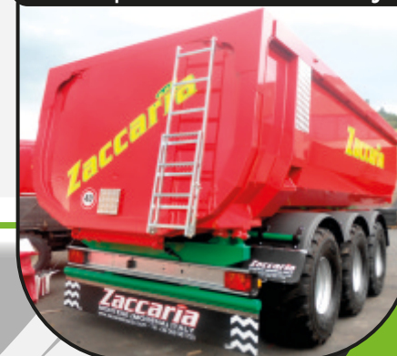
Portellone posteriore idraulico a tenuta stagna
