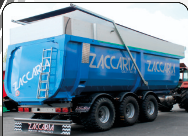
Copertura Flip-Tarp con rete in PVC
