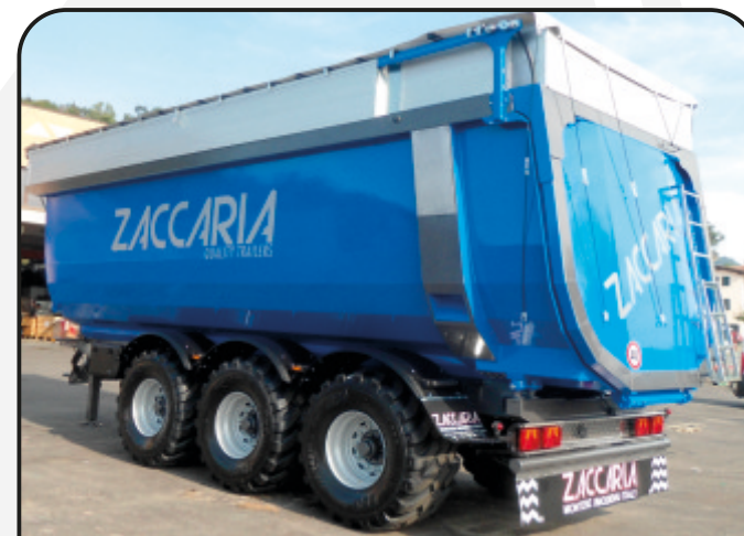
Copertura manuale montata sulle soprassonde in alluminio
