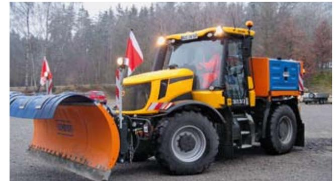
Die progressive Vorderachsfederung ermöglicht die gewünschten großen Federwege im unbelasteten Fahrzustand und wird spürbar härter mit zunehmendem Einsatzgewicht.
