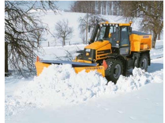
*Auslegerwerkzeuge werden stabil geführt durch die automatische Niveauregulierung in Verbindung mit der Heckkraftheberabstützung sowie der optionalen Vorderachsverriegelung.*
