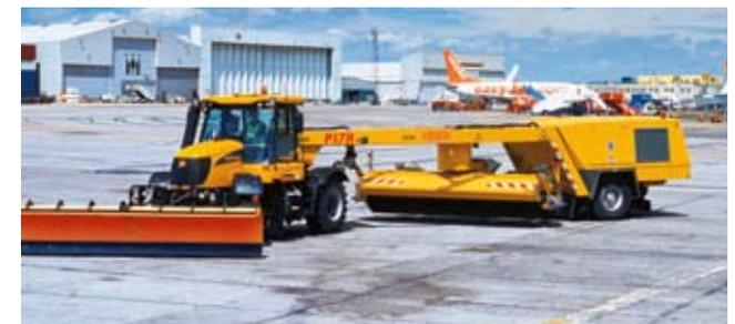
*Die leistungsstarken 3000 Modelle eignen sich hervorragend für die großflächige Räumung auf Flughäfen, wo auch aufgesattelte Gebläse mit Reinigungsbesen für die Start- und Landebahnen zum Einsatz kommen.*
