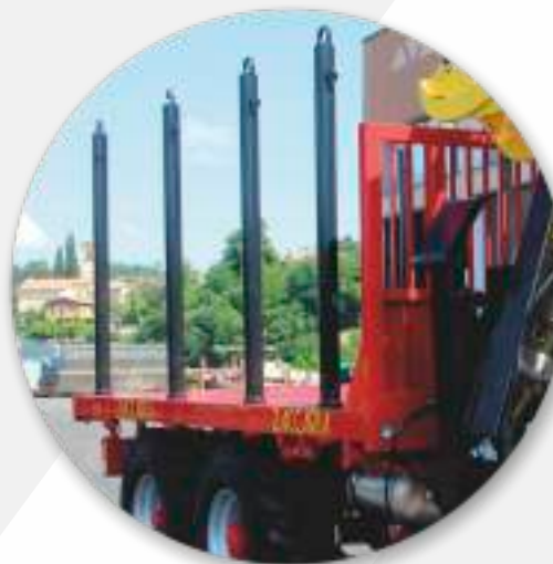
Stanti in acciaio spessore 10 mm da diam. 90 con vite di fissaggio alti 1,5 m con prolunga 80 cm.
