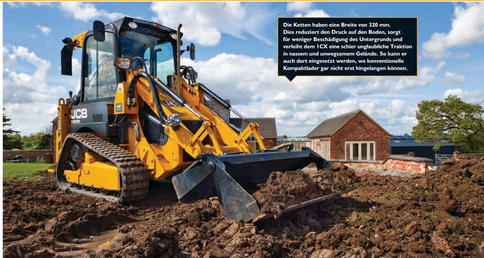
Die Ketten haben eine Breite von 320 mm. Dies reduziert den Druck auf den Boden, sorgt für weniger Beschädigung des Untergrunds und verleiht dem ICX eine schier unglaubliche Traktion in nassem und unwegsamem Gelände. So kann er auch dort eingesetzt werden, wo konventionelle Kompaktlader gar nicht erst hingelangen können.
