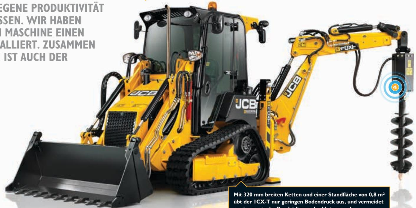
Mit 320 mm breiten Ketten und einer Standfläche von 0,8 m<sup>2</sup> übt der ICX-T nur geringen Bodendruck aus, und vermeidet so eine zu starke Beschädigung des Untergrunds.
