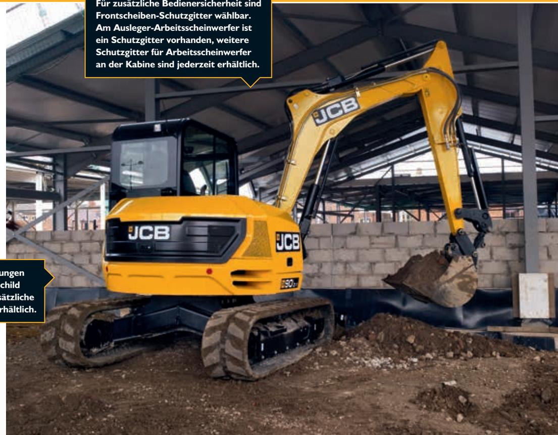
JCB-Midibagger zeichnen sich durch die höchste SAE-Wartungsnote auf dem Markt aus, beispielsweise durch Routinekontrollen die sich einfach und ohne Spezialwerkzeuge durchführen lassen sowie aufgrund der mit Gasdruckfedern um 30° kippbaren Kabine.
