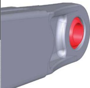
Die Enden der Hubzylinder und die rückwärtigen Drehpunkte der Ladeschwinge sind mit gehärteten Kugelgelenklagern ausgestattet. Sie gleichen Verwindungen aus und schonen die Lagerstellen.
