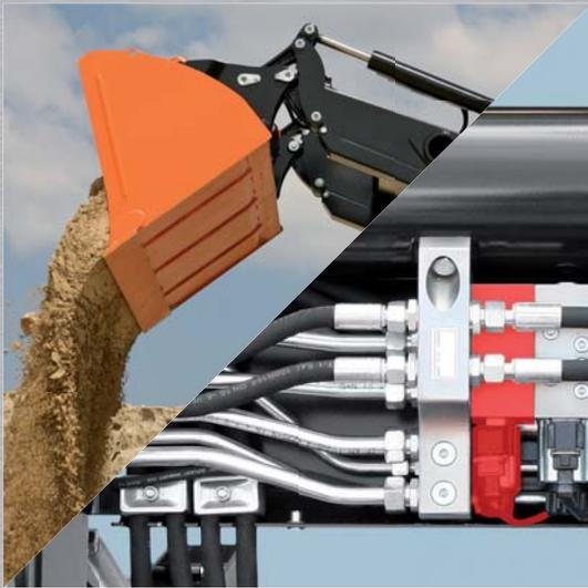
Die Schnellabkippung der „VX“-Frontladergeneration beschleunigt das Entleeren des Arbeitsgerätes. Das Ventil für diese Funktion wird ebenfalls an das „MCV“-System angebaut.
