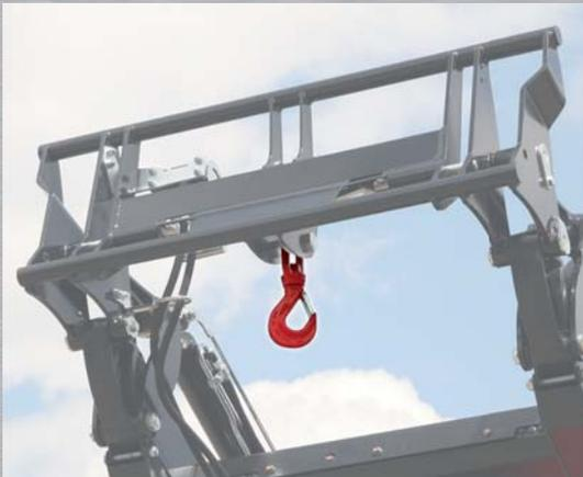
Lasthaken - Die Vorbereitung für die Befestigung des drehbaren Hakens ist serienmäßig an der Schnellwechseleinrichtung vorhanden.
