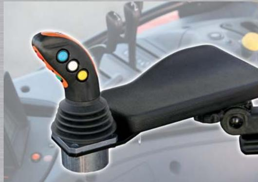
Das „ELC“-Einhebelsteuergerät ist ein elektroproportionales Steuergerät für die Laderfunktionen und Zusatzventile. Optional ist dazu eine fünffach verstellbare Armstütze lieferbar.
