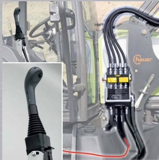
Alle Funktionen mit einem Griff. Mit dem Einhebelsteuergerät lassen sich die Laderarbeiten noch effizienter und rationeller gestalten. Das Monoblockventil wird direkt in das Hydrauliksystem des Traktors geschlossen.
