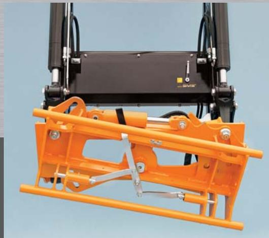
Dreheinrichtung integriert in die Geräte-Schnell-Wechseleinrichtung. Das Arbeitsgerät lässt sich jeweils 14° nach links und 14° nach rechts drehen. Auch mit hydraulischer Verriegelung lieferbar!
