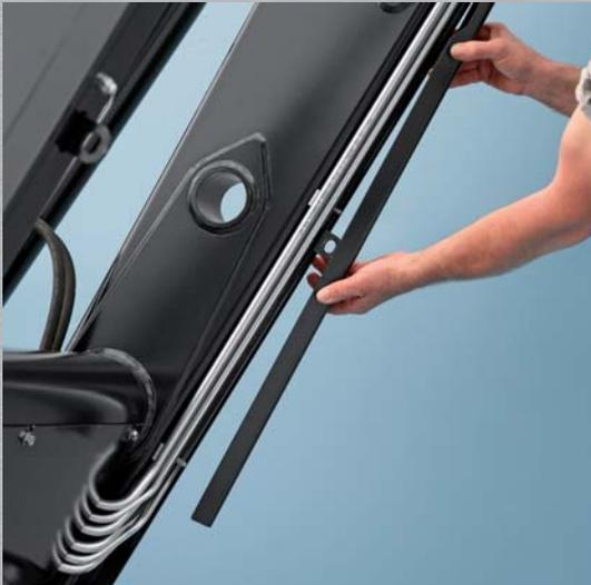
Ein zusätzlicher Vorteil des Schwingenprofils: die Hydraulikleitungen werden - geschützt durch Abdeckungen - unter der Ladeschwinge montiert. Die Ölversorgung erfolgt bis zum „MCV“-Ventil in Stahlleitungen.
