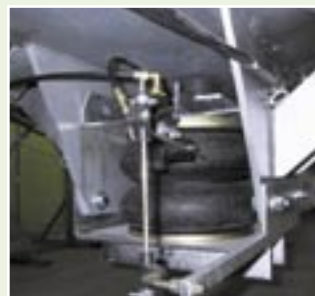
Luftfederbalg mit automatischer Regelung
