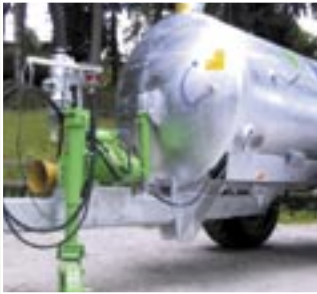
Zentraldeichsel hydraulisch verstellbar
