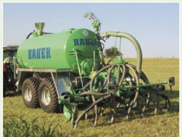
Kombifass K100TL 10.000 I mit Schneckenverteiler 15 m, Tandem-Boogie-Achse, Zentraldeichsel, Unterfahrschutz
