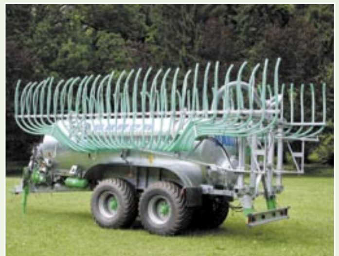
Kombifass K100TL 10.000 I mit Schneckenverteiler 15 m, Tandem-Boogie-Achse, Zentraldeichsel, Unterfahrschutz
