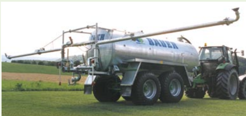
Vakuumfass V120TL 12.000 l, mit Doppeldüsenverteiler 18 m mit dritter Düse mittig, Entleerungseinrichtung
