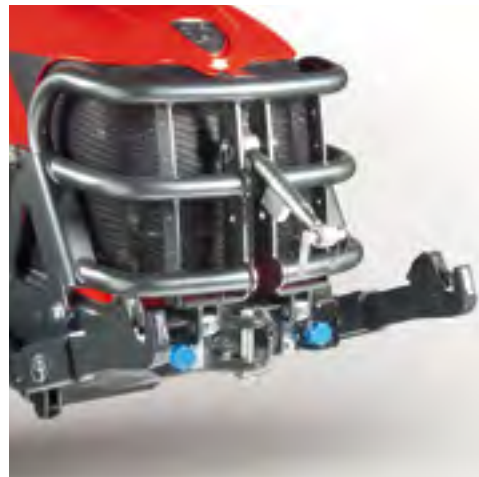
Der vordere Kraftheber* optimiert die Arbeit bei kombiniertem Einsatz mit heckseitigen Geräten.
