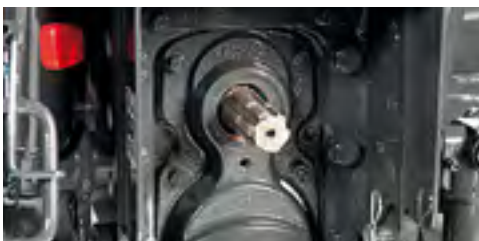
Zapfwelle mit zwei Geschwindigkeiten: 540 U/min, 540 E (750 U/min) mit den Schaltgängen synchronisiert. Der Zapfwellenstummel ist vom Typ ASAE 1 3/8 und für alle Geschwindigkeiten gleich.
