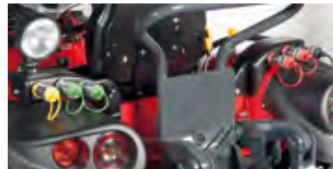
Hydraulikanlage mit einem einfachwirkenden und vier doppelwirkenden Verteilerventilen, einem Verteilerventil mit Dauerförderung und Ölrückflussanschluss.
